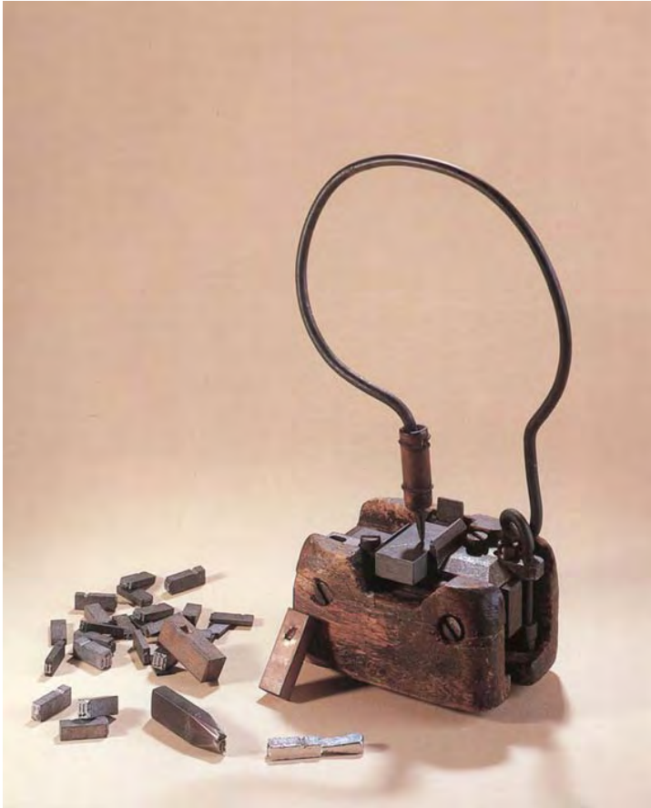
Abb. 3: Historisches Handgießinstrument mit Stempel, Matrizen und Typen
